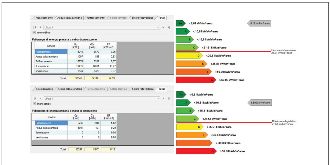
Fig. n. 5: Fabbisogno di energia primaria, con e senza contributo fotovoltaico, in presenza rispettivamente di 5 e di 2 servizi.
