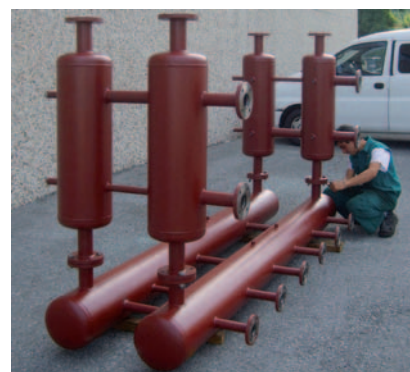
Esempio di collettore in esecuzione speciale.
