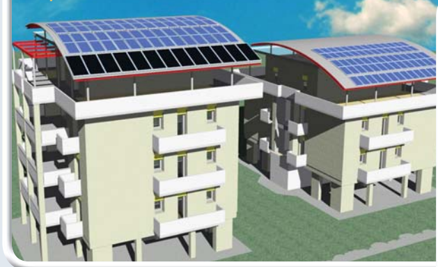
Copertura con collettori solari e moduli fotovoltaici
